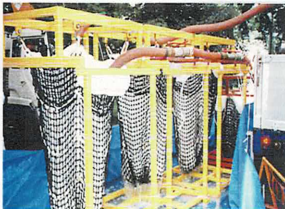
固液分離フィルタ(ドリームネット)で浄化された水を放流する様子
